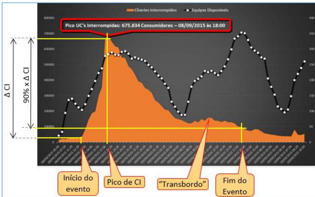
Gráfico 1 – Exemplo de identificação da faixa considerada para classificação de ocorrências num Evento Climático
