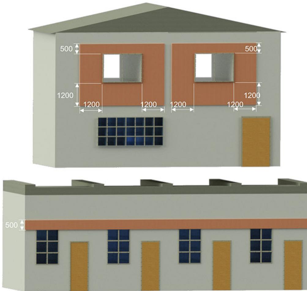
Locais onde não é permitida a fixação dos condutores do ramal de conexão na fachada.
