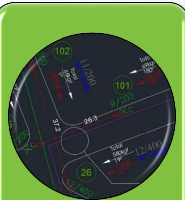
No Projeto informar o esforço resultante dos cabos (kgf ou daN) a serem instalados, em intensidade, direção, sentido e ponto de aplicação em cada poste, nas condições de construção
