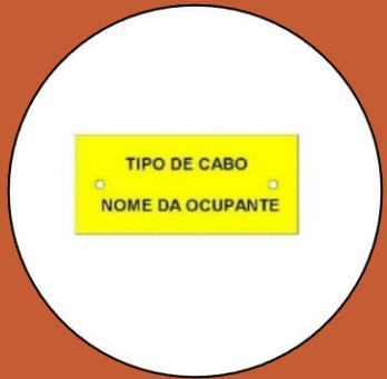
Apresentar a imagem da placa de identificação do cabo do ocupante (Anexo V) que será utilizada em campo, conforme ABNT NBR 15214.
