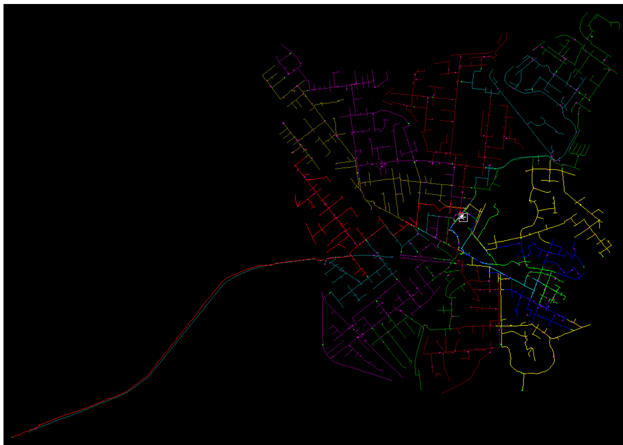
Figura 6 - Mapa Geométrico da subestação São Vicente 2 – Mário Brígido (MBR)
