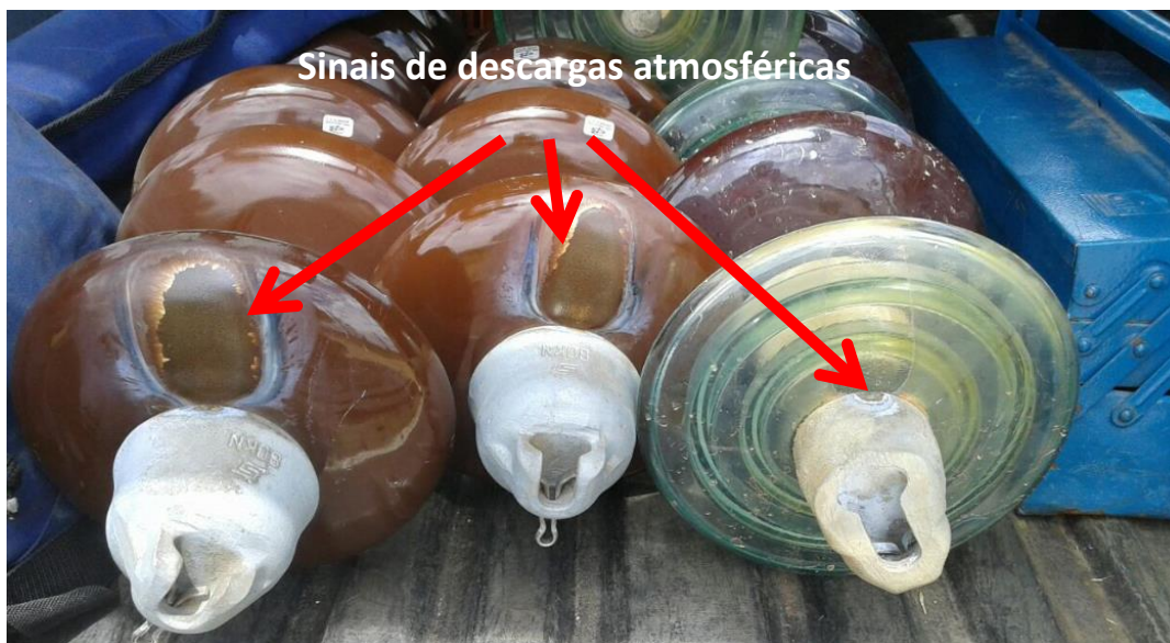
Figura 32 - Isoladores com sinais de descargas atmosféricas
