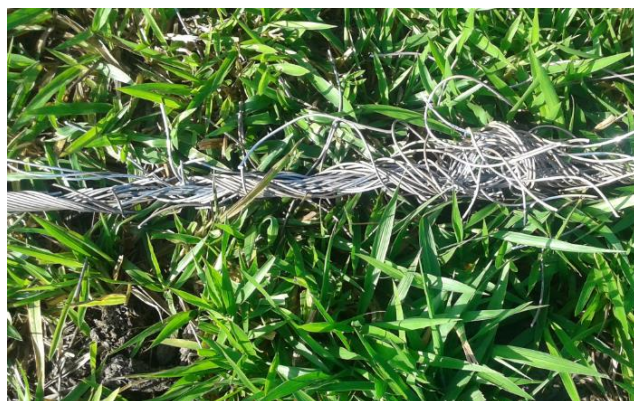
Fotos 11 - Cabo avariado do circuito 1
