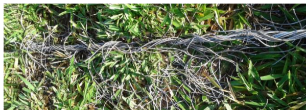
Foto 7 - Cabo avariado do circuito 1
