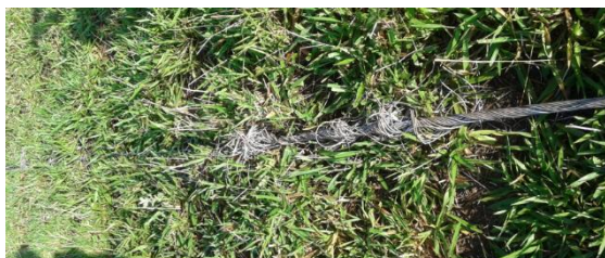
Foto 6 - Cabo avariado do circuito 1
