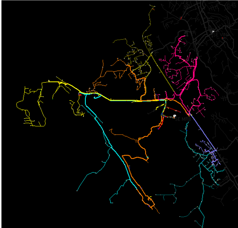
Figura 16 - Mapa Geolétrico da subestação Vinhedo 2 – Marambaia (MRB)
