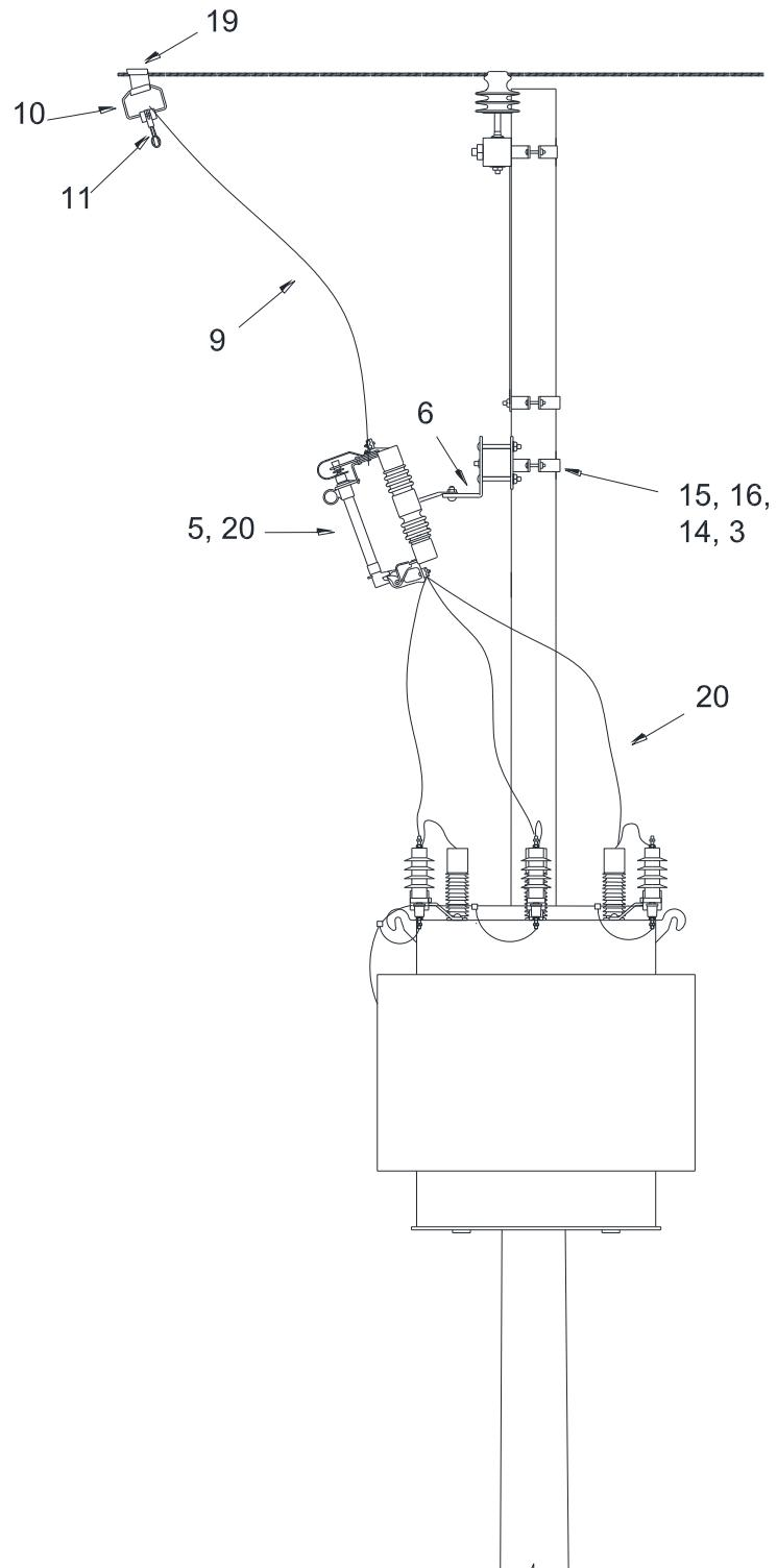
Distâncias de fixação da estrutura e equipamento transformador - ver item 6.6.
