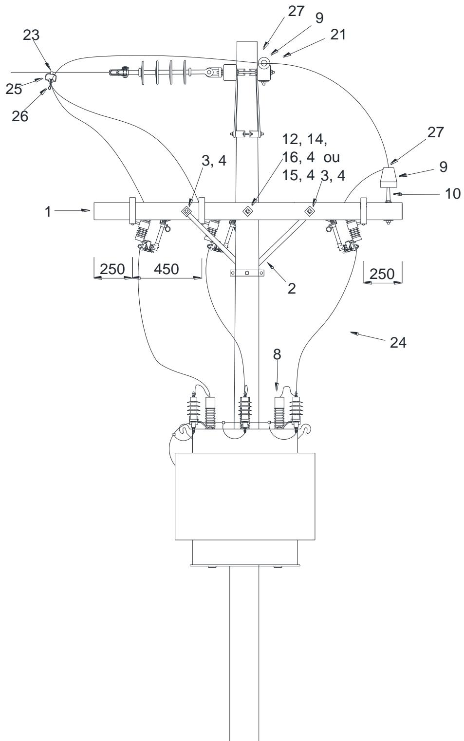
Distâncias de fixação da estrutura e equipamento transformador - ver item 6.6.
