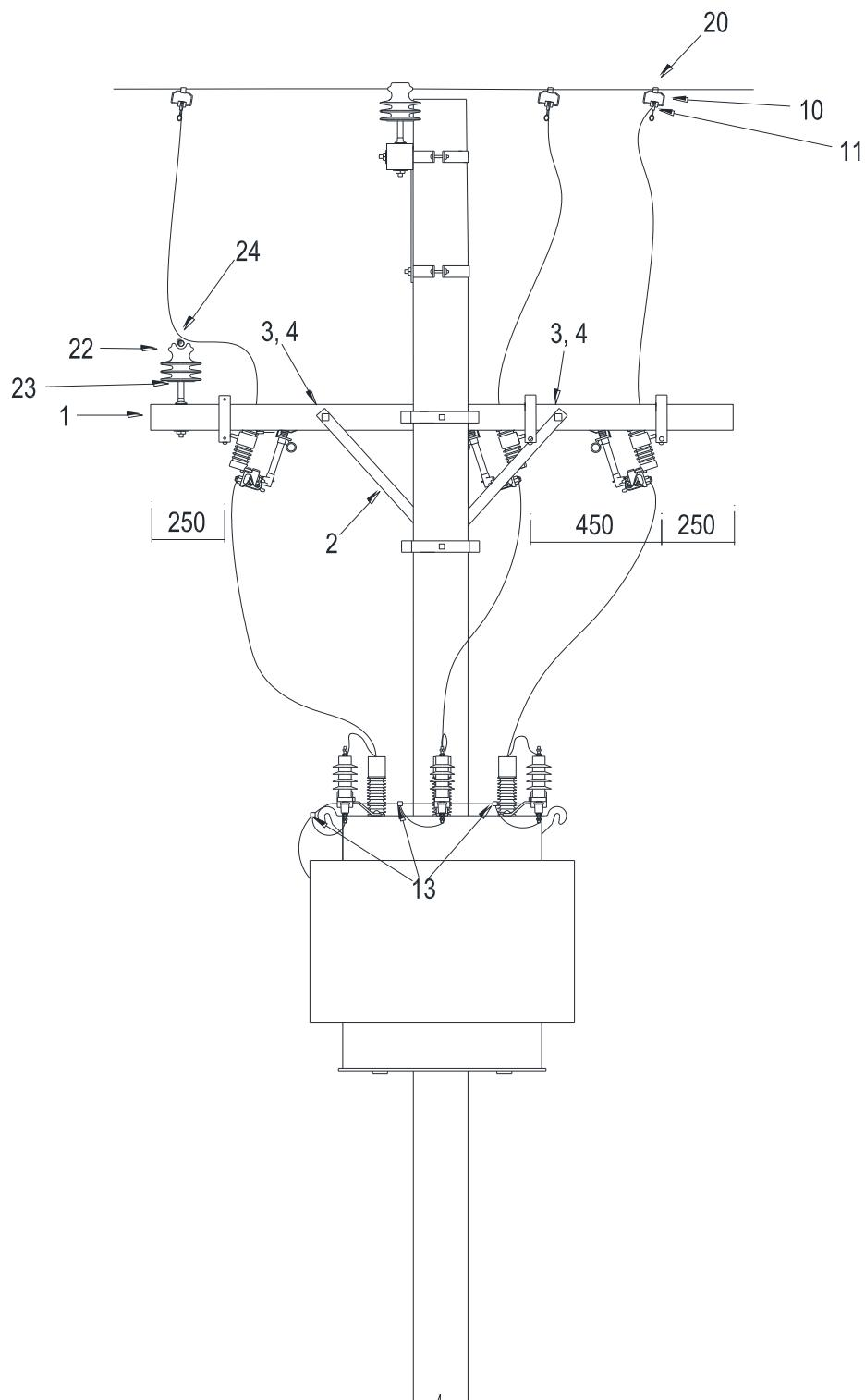
Para montagem com rede a 90° das chaves fusíveis, o transformador pode ser rotacionado.
